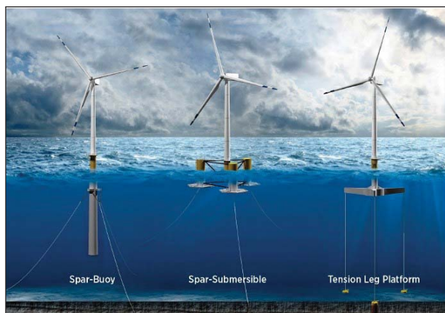
Рис. 1. Прототипы ветровых плавающих установок (по источнику [1])
