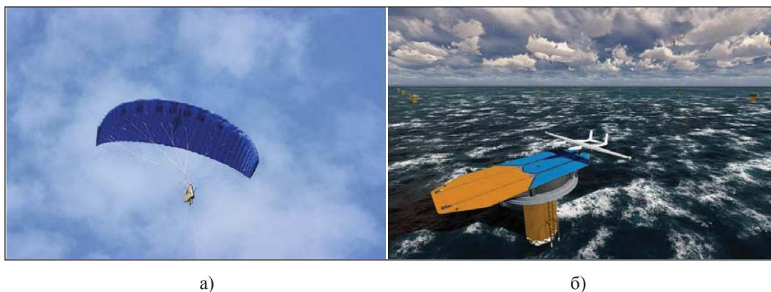
Рис. 2. Виды летающих ветрогенерирующих установок (по источнику [1]): а – воздушный змей; б – летательный аппарат на «поводке»
